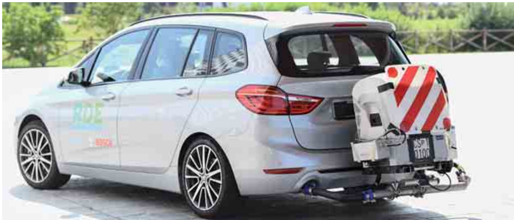
Una delle vetture utilizzate per il test RDE con il misuratore di emissioni agganciato al retrotreno
