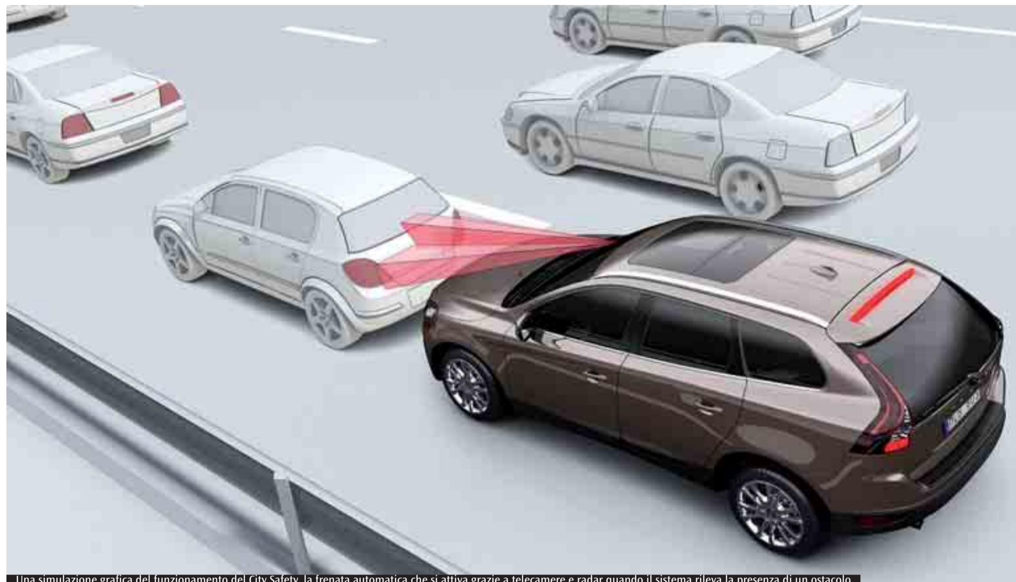
Una simulazione grafica del funzionamento del City Safety, la frenata automatica che si attiva grazie a telecamere e radar quando il sistema rileva la presenza di un ostacolo
