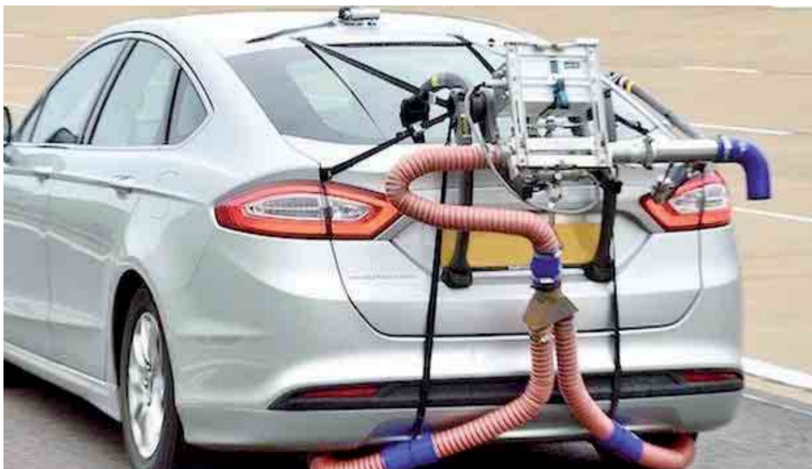
L'apparecchiatura di rilevazione di consumi ed emissioni applicata ad una vettura: il nuovo ciclo di omologazione Wltp risulterà più verosimile
