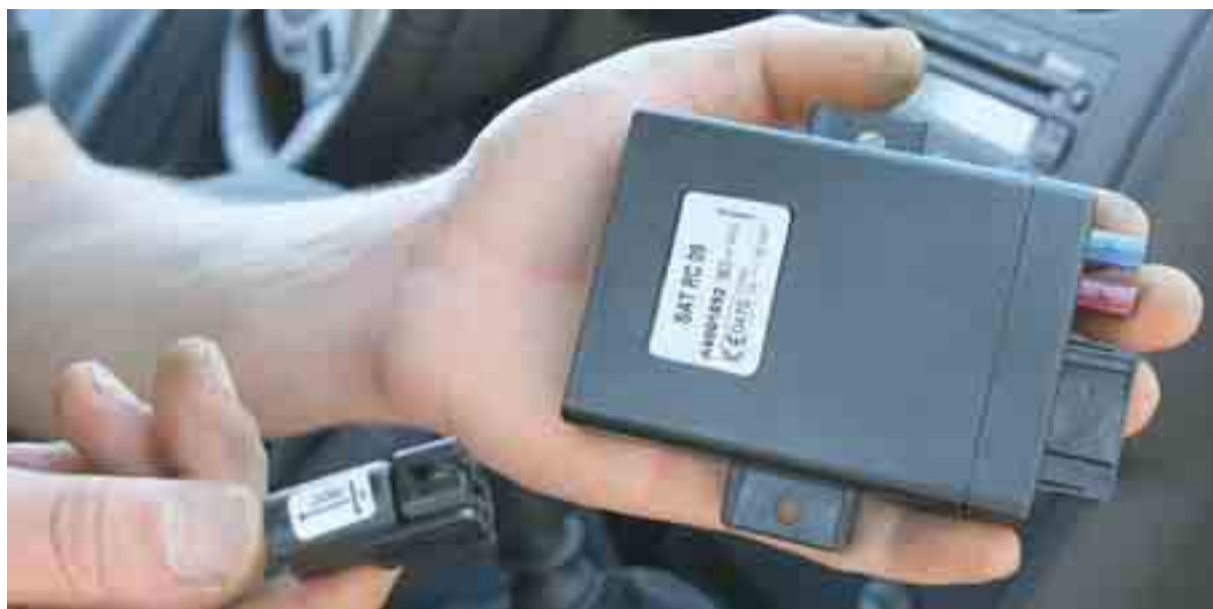
Una scatola nera per automobile, l'apparecchio che registra tutti i dati di circolazione della vettura sulla quale è montata
