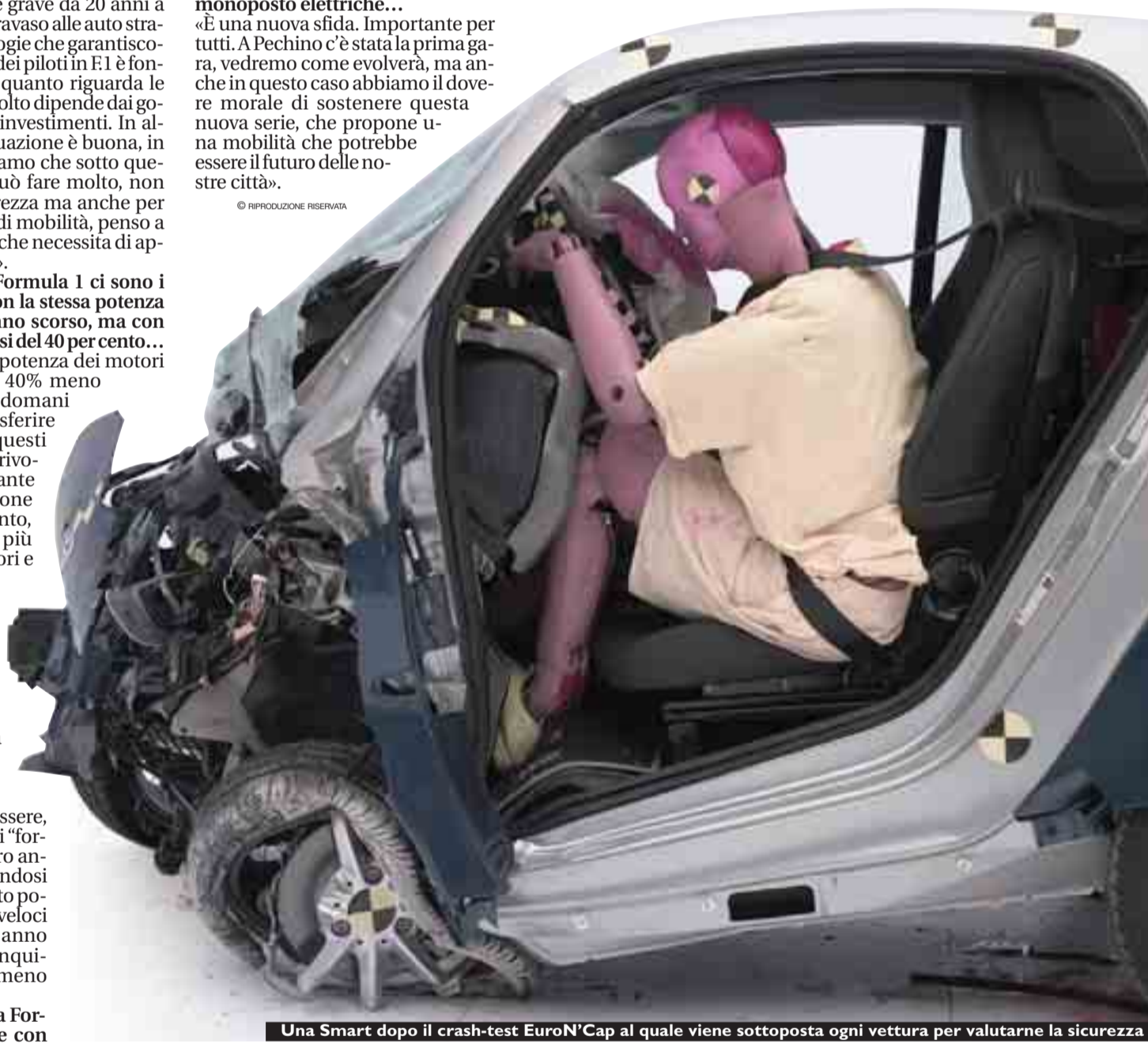
Una Smart dopo il crash-test EuroN'Cap al quale viene sottoposta ogni vettura per valutarne la sicurezza
