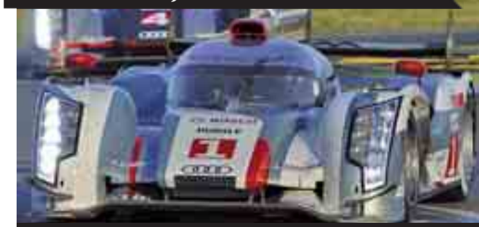
Audi ha dominato l'80° edizione della 24 Ore di Le Mans conquistando un altro primato: quello della prima vittoria di una vettura ibrida. L'Audi R18 e-tron quattro è infatti dotata di un V6 turbodiesel di 3,7 litri da 510 Cv che aziona le ruote posteriori, mentre all'avantreno è presente un gruppo elettrico sviluppato con Bosch che genera corrente in frenata e la rilascia quando l'auto supera i 120 km/h.
